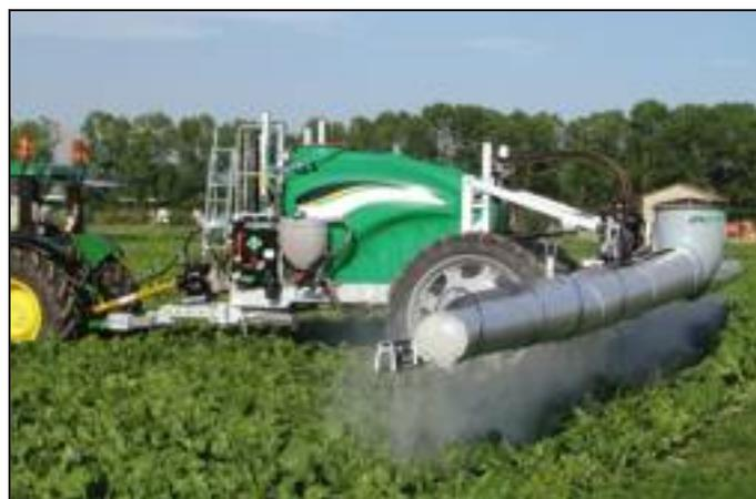
[ L'impiego di **barre** distributrici munite di maniche ad aria evita l'effetto deriva migliorando ulteriormente la qualità della distribuzione del concime.
